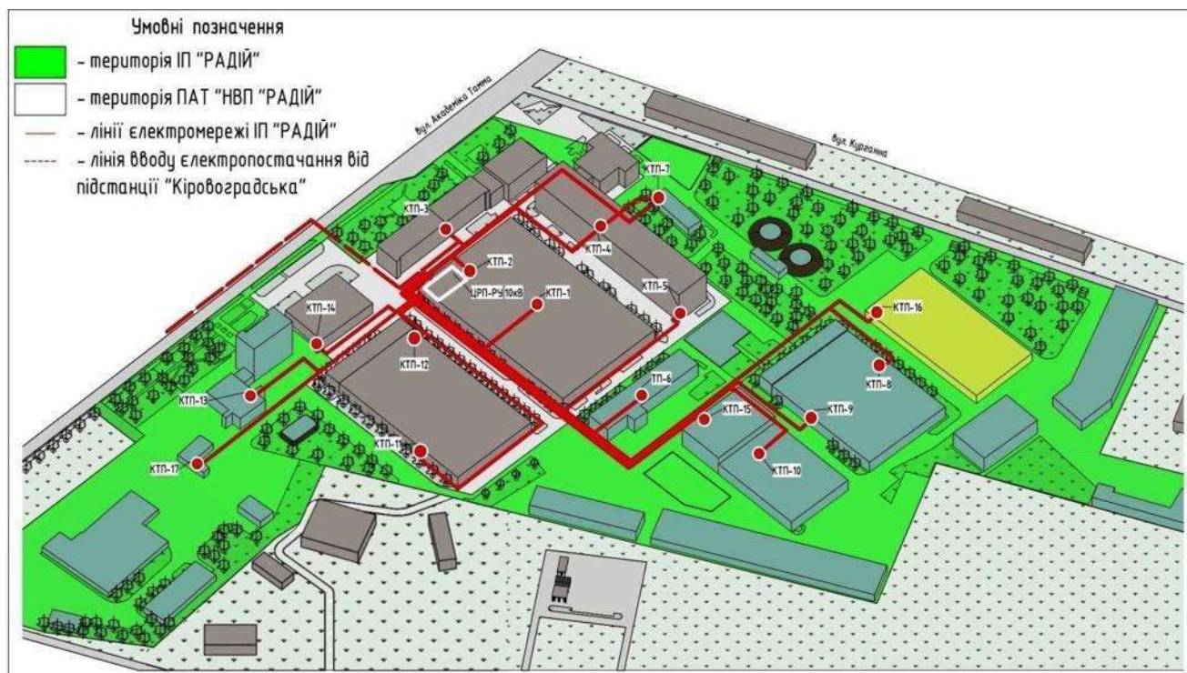
Мал. 4. Схема розташування мереж і об'єктів системи електропостачання
